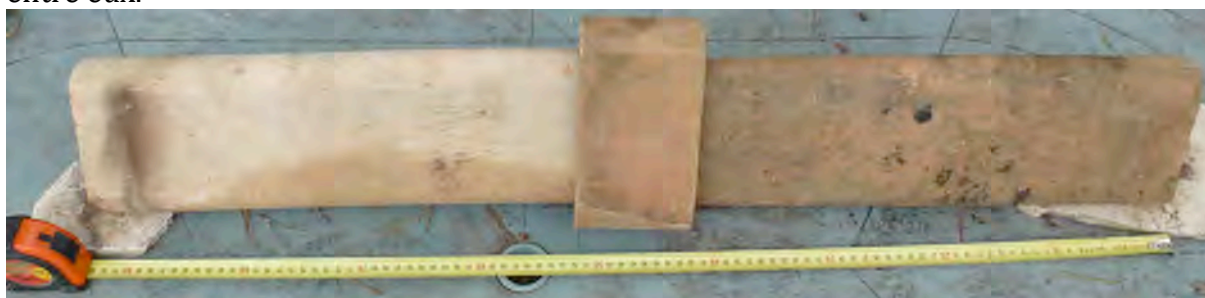
Photos 6,7, et 8 du système de transfert d'eau en terre cuite présent sur toute la zone.
